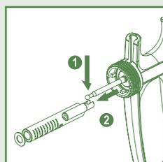
Montare il pistone nel fusto. Collegare l'asta.
