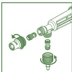
Svitare e lavare le valvole. Non inserire alcun utensile all'interno delle cartucce delle valvole.
