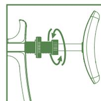
Ruotare il raccordo per muovere il pistone.
